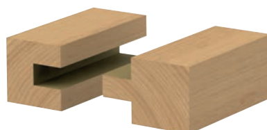
Połączenie na pióro-wpust
